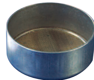
olla de granulado* ∅ interior 97 mm altura al interior 40 mm
