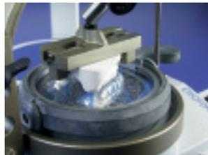
**4.** Nach dem Abkühlen den Occluform öffnen und das Modell entnehmen. **(14 b).**
