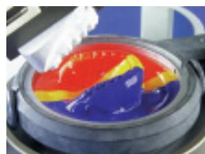
14 a. Nach dem Abkühlen den Occluform öffnen und das Modell entnehmen. (14 b)
