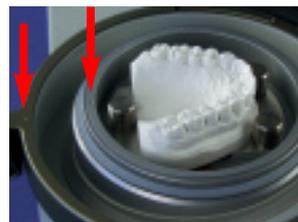
2. Den Modelltopf so in das ERKOFORM-RVE-Gerät einsetzen, dass sich die Markierungen (Pfeile) gegenüber liegen.
