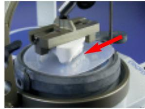
**3.** ...den Occluform rasch ganz schließen. Dadurch entsteht eine okklusale Ebene mit eingepprägten Höckerspitzen.
