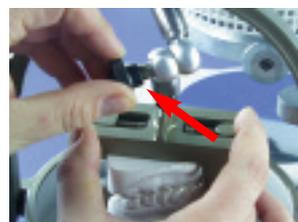
6. Das Arretierungsgelenk wird in dieser Position geschlossen.
