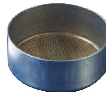
Contenitore per granulato* Ø interno 97 mm altezza interna 40 mm
