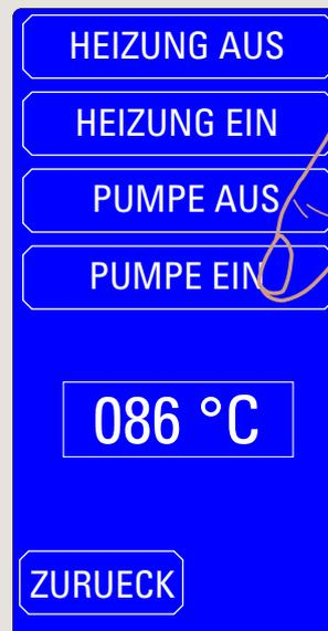
Zur Prüfung der Tiefziehfähigkeit die Folie nach außen schwenken (b) und mit einem stumpfen Instrument abtasten, bleiben Eindrücke zurück, ist die Folie in der Regel tiefziehfähig. Die Heizung schaltet ab, wenn die Folie aus dem Heizbereich herausgeschwenkt wird, "Heizung aus" gewählt wird oder der Sensor  $>240\text{ °C}$  misst.
