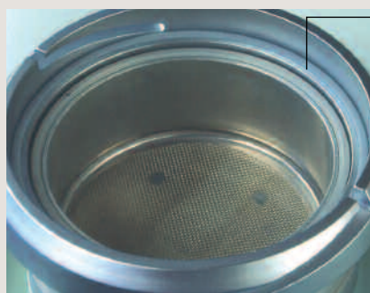
Guarnizione telaio portadischi 188 011
